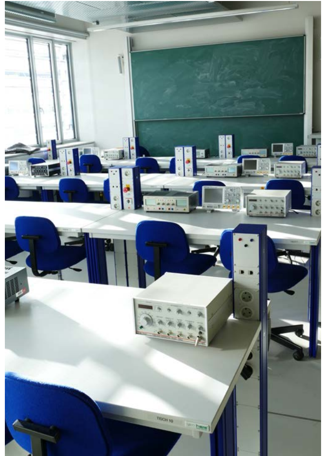
Abb. 20 sichere Anschlusspunkte in einem Übungsraum
